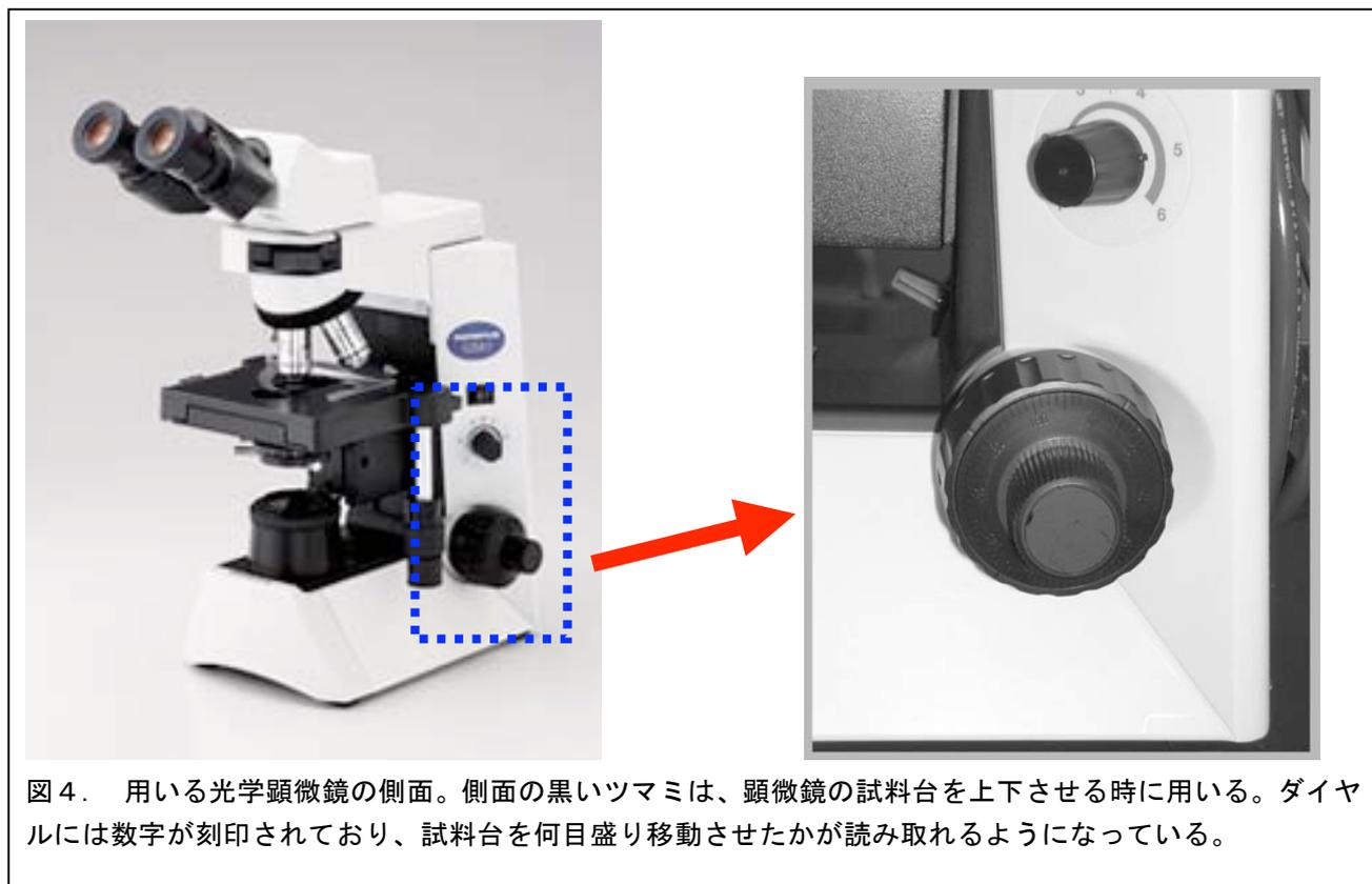
図4. 用いる光学顕微鏡の側面。側面の黒いツマミは、顕微鏡の試料台を上下させる時に用いる。ダイヤルには数字が刻印されており、試料台を何目盛り移動させたかが読み取れるようになっている。
